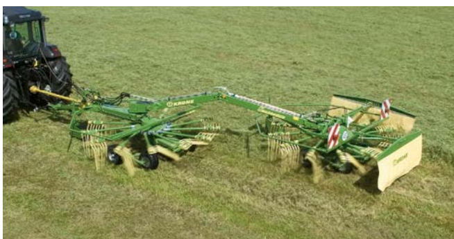
Andaineur latéral deux rotors Swadro 710/26T Largeur de travail 6,20 m ou 2 x 3,40 m
