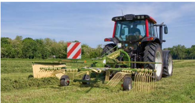
Andaineur mono rotor Swadro, porté Largeurs de travail de 3,50 m à 4,60 m
