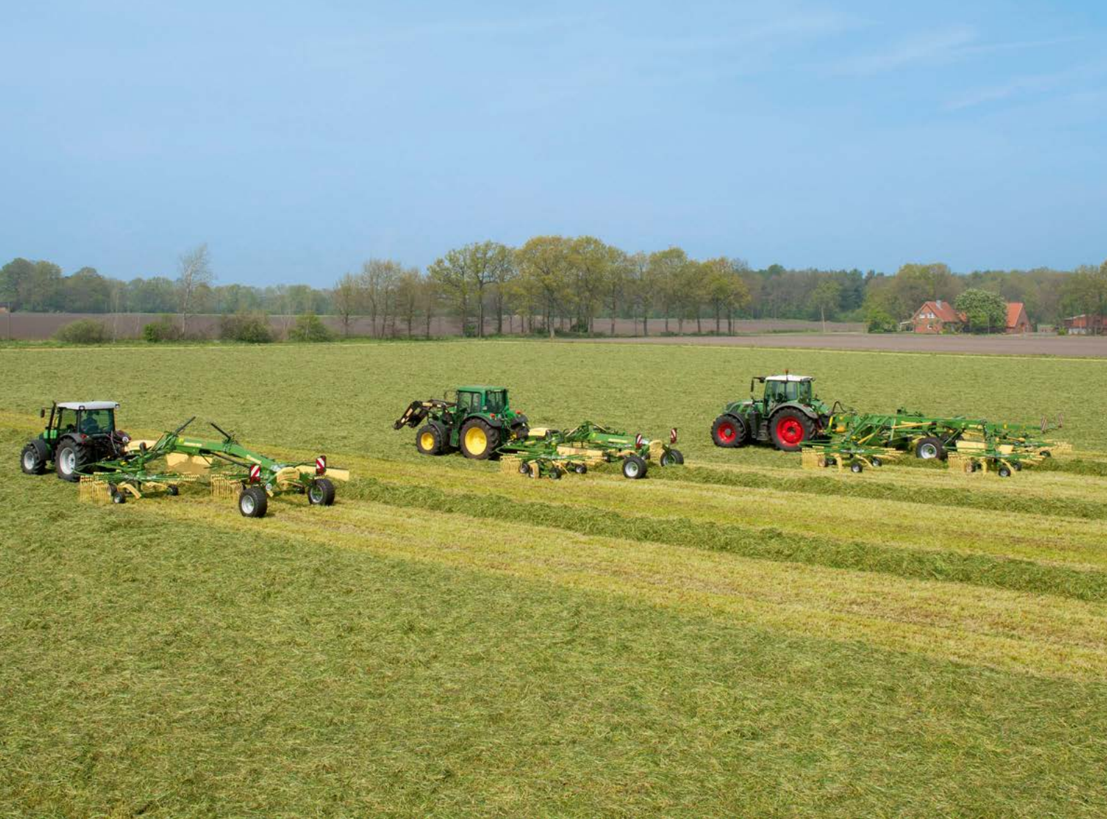
Andaineur central quatre rotors Swadro TC 1250 Largeurs de travail variables de 9,80 m à 12,50 m
