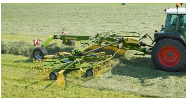
Andaineurs centraux deux rotors Swadro TC et TC Plus Largeurs de travail variables de 5,70 m à 10,00 m
