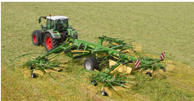
Andaineurs centraux quatre rotors Swadro 1400 et 1400 Plus Largeurs de travail variables de 11,00 m à 13,50 m
