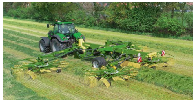
Andaineur central quatre rotors Swadro TC 1370 Largeurs de travail variables de 10,80 m à 13,70 m
