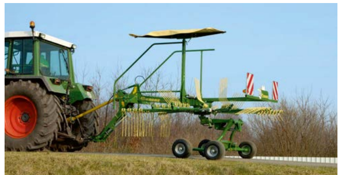
Andaineur mono rotor Swadro, traîné Largeurs de travail de 3,80 m à 4,60 m
