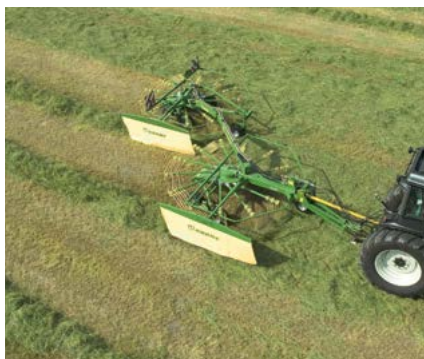
Dépose de deux andains Deux andains sur 6,80 m
