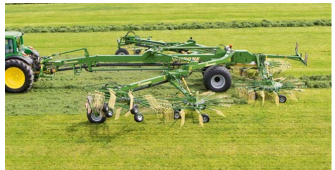
Andaineur central six rotors Swadro 2000 Largeurs de travail variables de 11,00 m à 19,00 m
